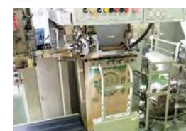
自動給袋機により、 計量からミシン掛けまでの 全工程が自動化
